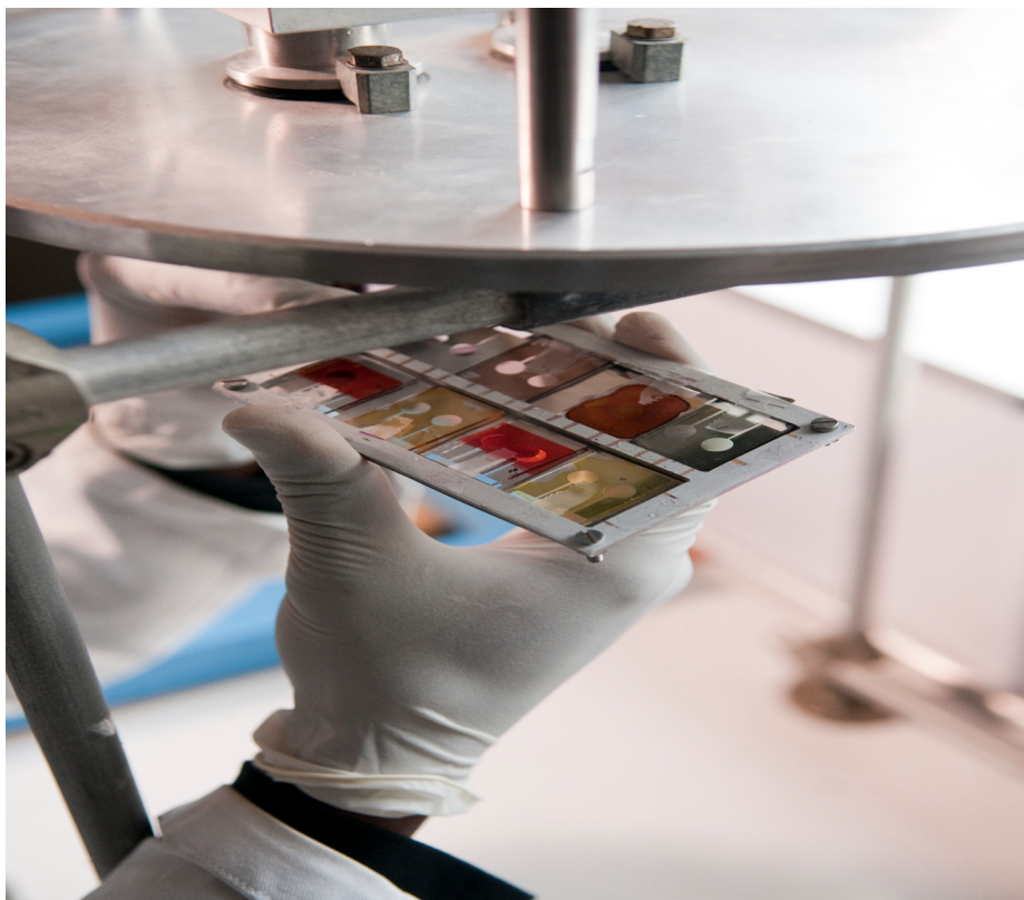
Portant d'électrodes d'ITO (oxyde d'indium et d'étain) disposé dans un évaporateur. Ces électrodes sont recouvertes de divers composés organiques colorés. L'évaporateur permet le dépôt d'une électrode en aluminium pour former ainsi une cellule solaire organique. © CNRS Photothèque - FRESILLON Cyril
